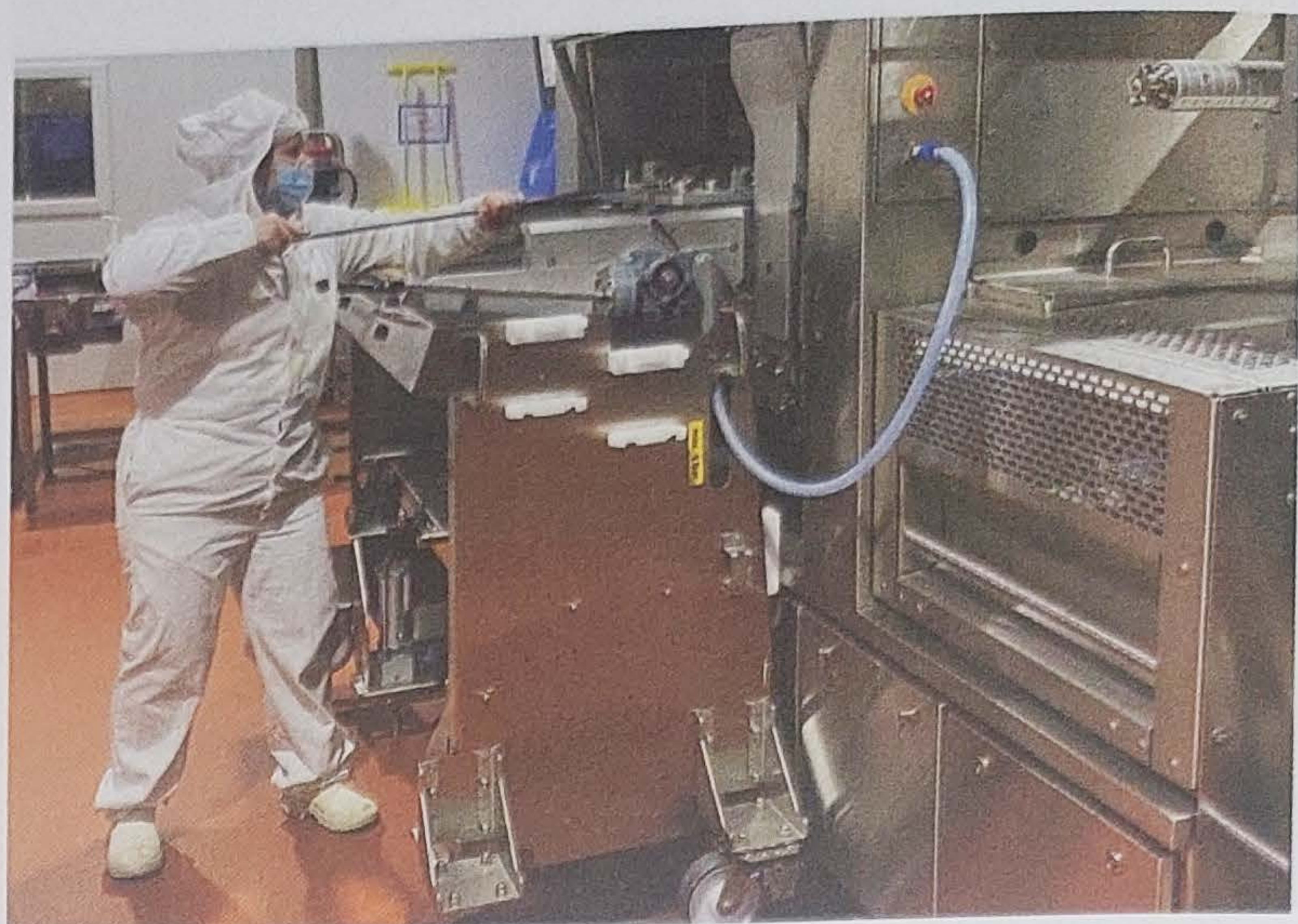
Grâce au chariot ergonomique, le changement d'outils se fait sans port de charges.
