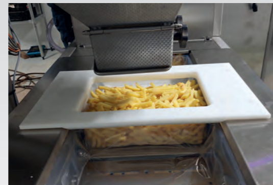
■ Masque de protection des soudures
