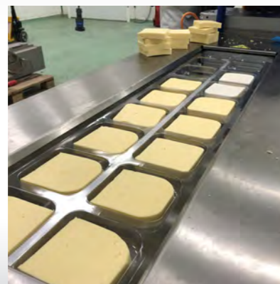
■ Thermoformeuse modulaire - Gamme Optimus avec le module de dépose étiquettes
