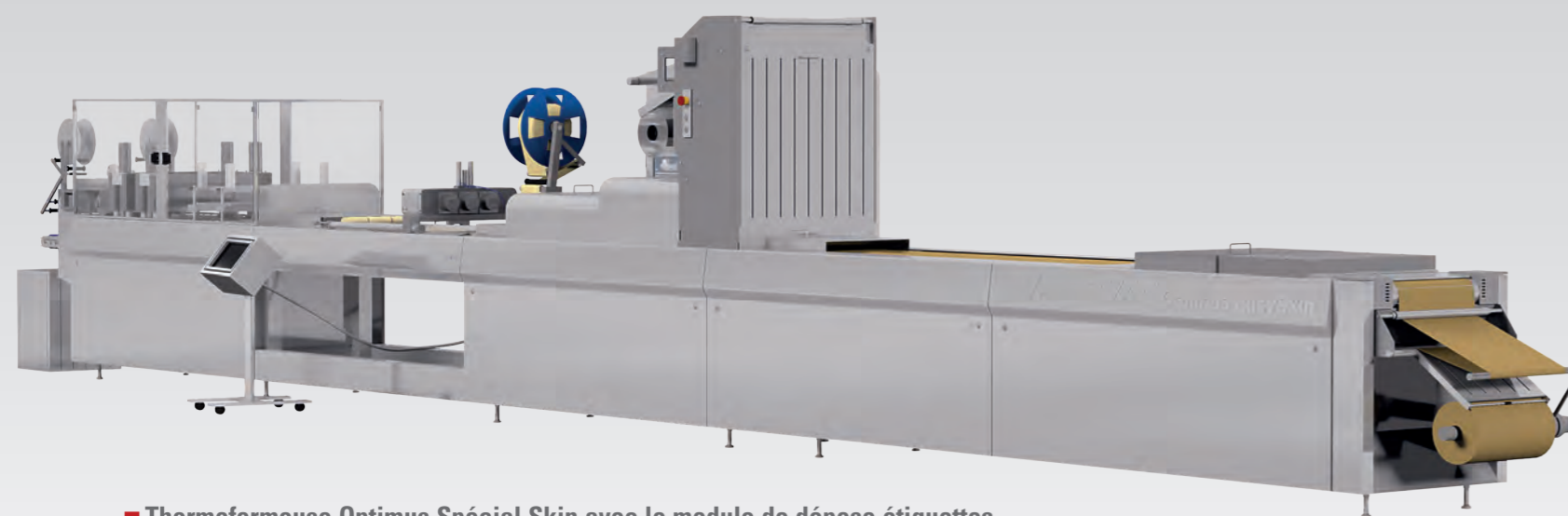
■ Thermoformeuse Optimus Spécial Skin avec le module de dépose étiquettes
