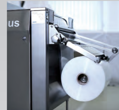
■ Bobine inférieure avec bras tendeur
