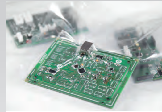
■ Protection contre l'oxydation
