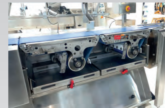
■ Porte bobine inférieur avec Servomoteur
